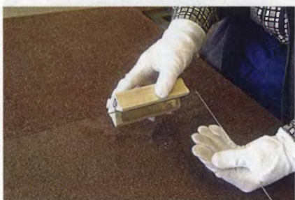
Притупление острых кромок, образовавшихся на стекле после его разлома, с помощью углового оселка...
