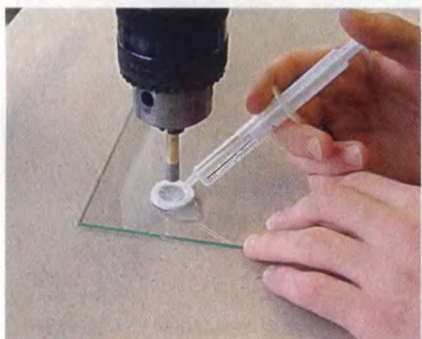
Подавать СОЖ удобно с помощью шприца. Пластиковое кольцо служит для удержания жидкости в зоне сверления.
