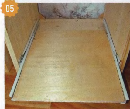
05 К дну ящика по бокам прикрепил направляющие выдвижного механизма.
