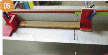
05 На концах каждой рейки крыши циркулярной пилой сделал пазы.
