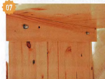
07 Столешницу соединил с боковинами пеналов болтами с колпачковыми гайками.
