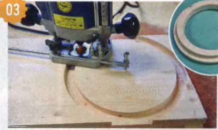
03 Из щита фрезерной машиной вырезал рамку для лаза...
