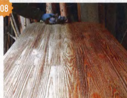
07 Нанесение контрастной лазури и её быстрое удаление с выступающих поверхностей с помощью ветоши.
