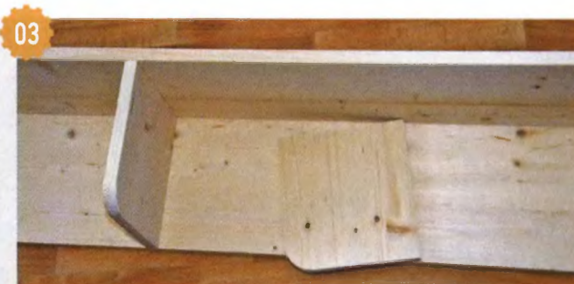
02 Каркасы пеналов собраны. Сборка центральной полки.
