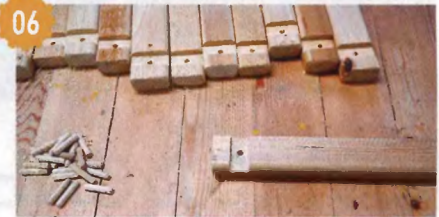
06 Для крепления брусков в пазах просверлил отверстия под шканты.
