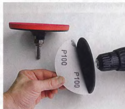
Шлифовальная насадка на дрель — эластичный круг с липучкой для крепления водостойкой шлифовальной шкурки.
