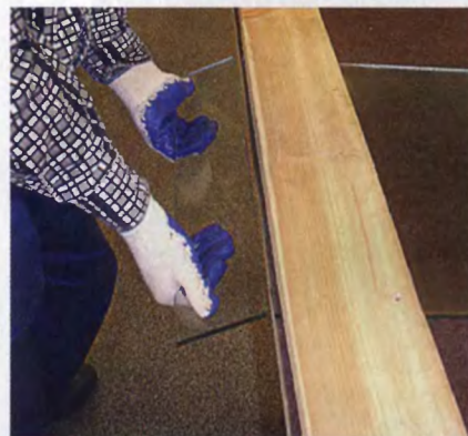
...а затем, совместив рез с кромкой стола и зафиксировав стекло, обеими руками обламывают его.
