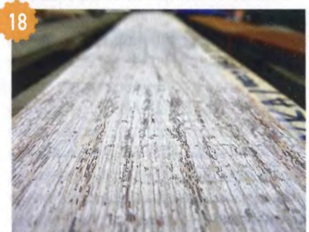
18 Поверхность, состаренная методом двойного окрашивания с последующей зачисткой.
