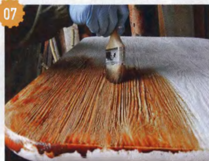
07 Нанесение контрастной лазури и её быстрое удаление с выступающих поверхностей с помощью ветоши.
