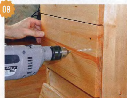
08 При сверлении крепёжных отверстий в передних стенках ящиков лицевые панели использовал в качестве кондукторов.
