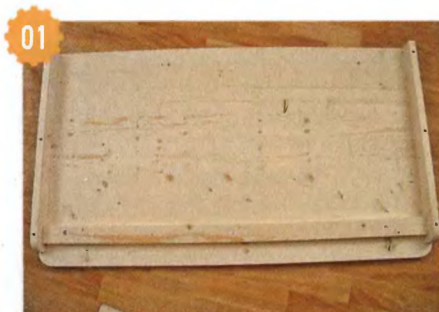
01 Столешницу снизу усилил тремя рейками.
