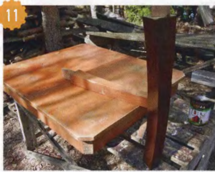
11 Окраска старого стола смесью молотковой эмали Hammerite и лазури Belinka.
