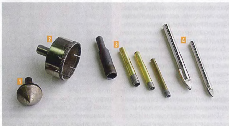
Алмазные сверла для стекла малых диаметров (0,8; 1 и 1,2 мм).
