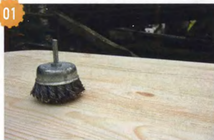
01 Обработка столешницы журнального столика жёсткой металлической щёткой.
