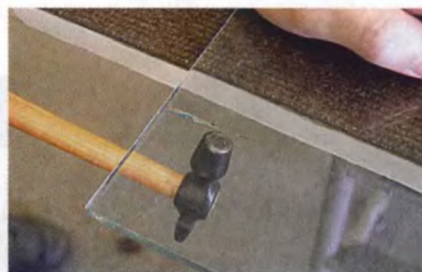
Начало и конец реза на толстом стекле простукивают снизу маленьким молотком...
